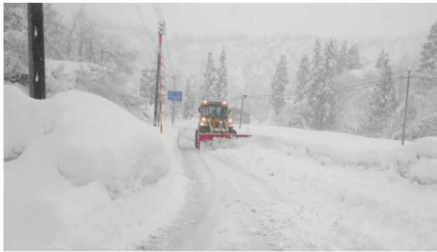
・除雪ドーザー
